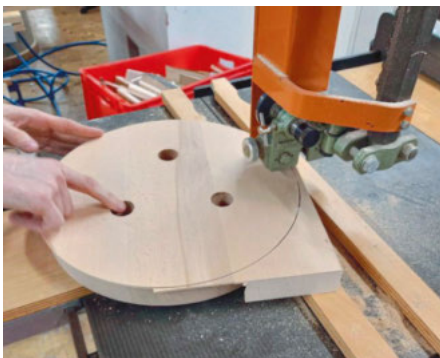
Rundschnitt mit Kreisfix an der Bandsäge. Die Bohrungen entstehen auf der CNC
