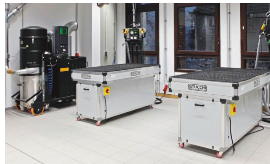
Mobile Schleiftische im Multifunktionsraum, darüber hängen Absaugampeln
