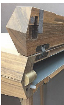
Das 3D-Scharnier von Häfele hält das Vorderstück und lässt es unter der geöffneten Klappe hängen
