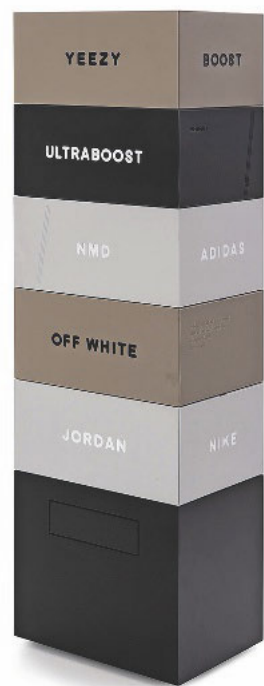
Sneaker Pfeiler »Twisted«. Schubkastengehäuse und Doppel aus Spanplatte, belegt mit Corian und Fenix, Schubkästen in amerikanischem Nussbaum, Sockel CDF. Alexander Kottmüller, Meisterschule München, 2018
