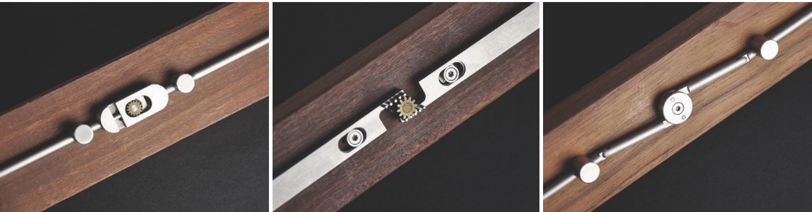
Eine Idee, drei Varianten: links mit Ritzel und Zahnprofil im Langloch, in der Mitte die Raumsparvariante, rechts mit Exzentergetriebe
