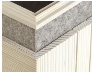
Die beiden Stirnseiten aus Tanne-Schichtholz laufen auf Gehrung mit den massiven Friesen des Korpus zusammen
