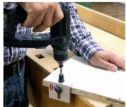
Durchdacht und einfach: die Bohrschablone für das Schlüsseloch des lösbaren Verbinders
