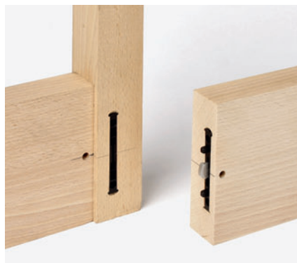
Clamex P: selbstspanend und lösbar, aber für den Stollenbau ohne zusätzliche Dübel zu schwach
