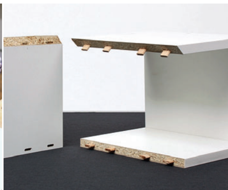
Domino bietet die Einstellung »mit Spiel«, das erleichtert das Einfädeln der Bauteile
