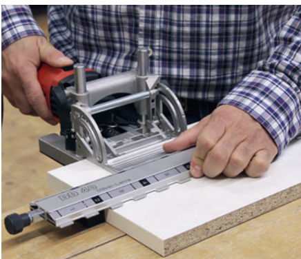
Duo Dübler von Mafell: Handhabung gut, selbsterklärend, aber hoher Kraftaufwand bei Hirnholz
