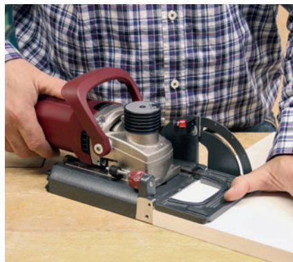
Lamello Zeta mit dem Verbinder Clamex P: die flinkste, aber auch teuerste Lösung
