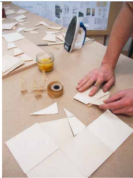
Statt einer Fugenverleimung wurden die Einzelteile rückseitig mit Furnierklebeband zusammengefügt
