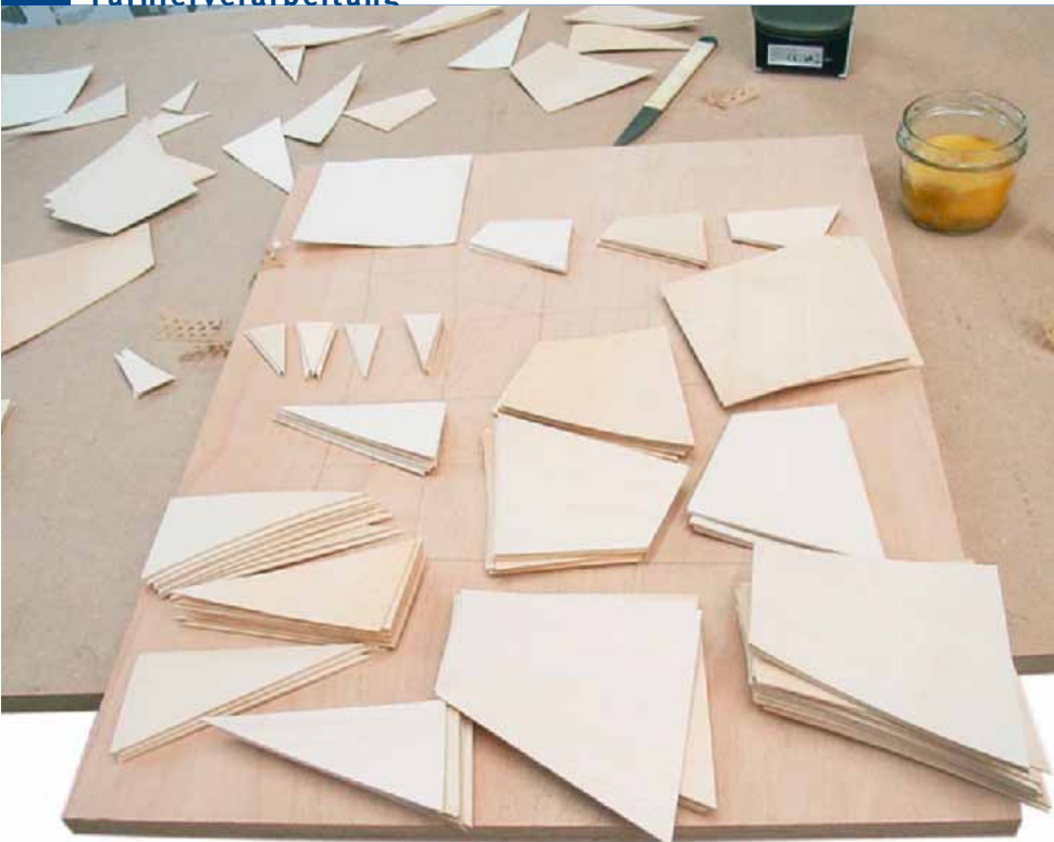
Sieben verschiedene Schablonen waren für den Zuschnitt auf der Formatkreissäge erforderlich
