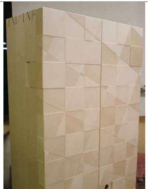
Die beiden Furnierfronten der Türen bestehen aus mehr als 500 Einzelteilen
